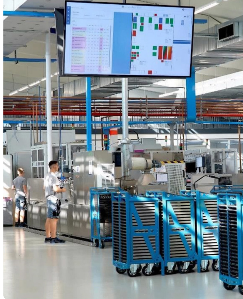
Visual Shop Floor – Andon Board bei GKN
